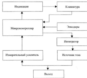
Рисунок 1.1- Функциональная схема гальванизатора «Поток-Бр»
